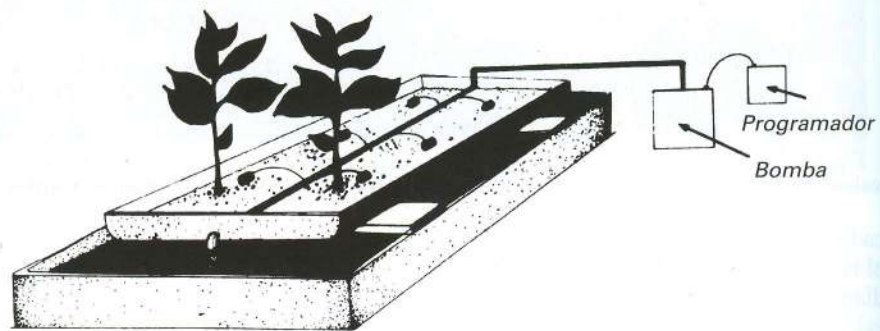
Fig. 8.25. Sistema sencillo de cultivo en arena con goteo a escala reducida.
