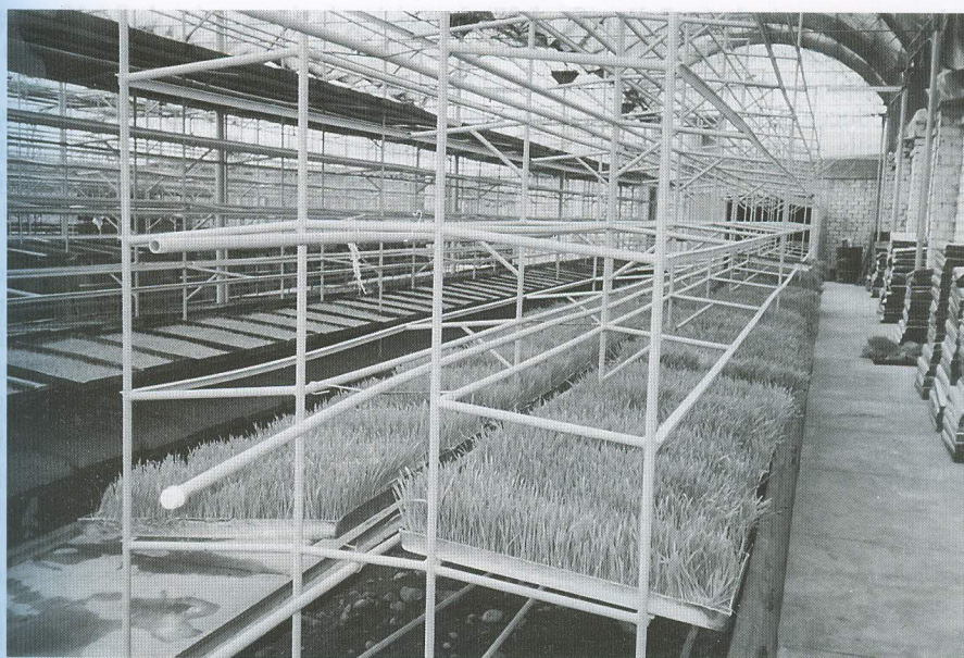
Fig. 5.25. Unidad hidropónica para forrajes con estantería en una nave parcialmente protegida de la luz. (Cortesía de V. Enrique Valdivia Benavides, Perú).
