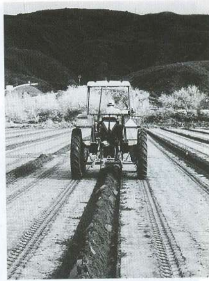
Fig. 6.67. Formación de arcenes de 10 pies mediante un tractor que arrastra un doble disco. (Cortesía de California Watercress, Inc., Fillmore, CA).
