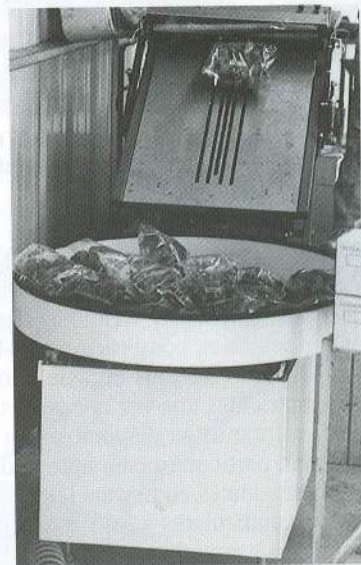
Fig. 6.58. Envasado de lechugas en bolsas de plástico cerradas herméticamente al calor. Mesa de clasificación en la base de la máquina selladora al calor. (Cortesía de F. W. Armstrong Greenhouses Inc., Oak View, California).
