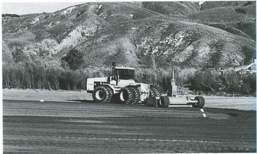
Fig. 6.65. Nivelación por láser de un campo de 3 acres. (Cortesía de California Watercress, Inc. Fillmore, CA).
