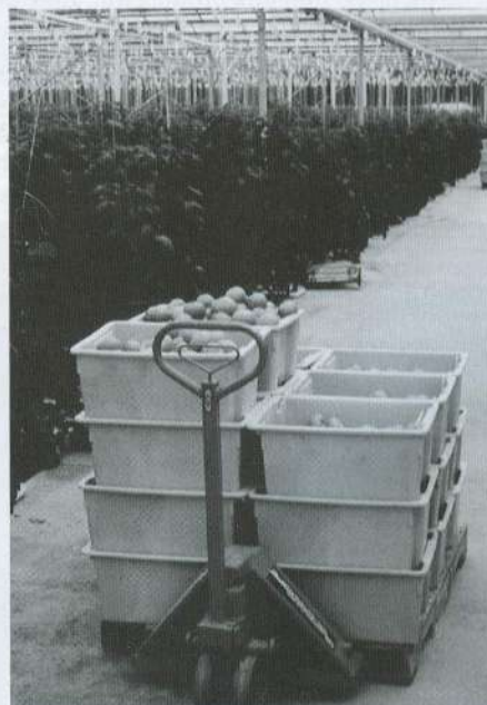
Fig. 9.12. Plataforma empleada en el transporte de recipientes de carga «paletizados» en la zona de envasado del invernadero. (Cortesía de Gipaanda Greenhouses Ltd., Surrey, Canadá).
